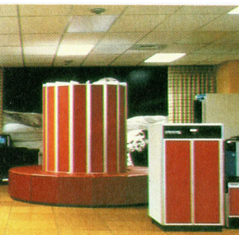
Das Erscheinungsbild des Cray-1 ist unverwechselbar. Der Computer befindet sich in einem kreisförmig angeordneten Gebilde. Die Stromversorgung liegt unter den runden Sitzbänken.
